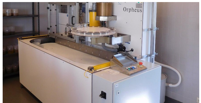
2. De AZC (Geautomatiseerde Zonale Centrifuge) is gespecialiseerd om tot 95% van alle aanwezige nematoden in een grondstaal (100 ml) te verzamelen in een kleine beker (40 ml nematoden suspensie).
